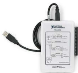
Hình 9. Module LabVIEW NI myDAQ dùng phân tích tín hiệu thu và phát
